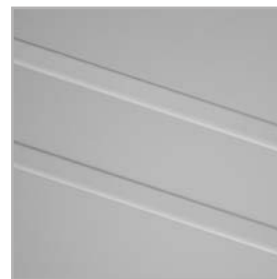
frézování na povrchu křídla v šířce 15 mm u vzorů B12
